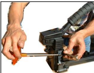
ОСЛАБЬТЕ ВИНТЫ (508), (509) И ГАЙКУ 8 ММ ГАЕЧНЫМ КЛЮЧОМ И 4 ММ ШЕСТИГРАННЫМ ГАЕЧНЫМ КЛЮЧОМ.
