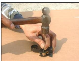
СНИМИТЕ ПРУЖИННЫЙ ШТИФТ (523) С ПОМОЩЬЮ МОЛОТКА И ШТИФТА ДИАМЕТРОМ 4 ММ.
