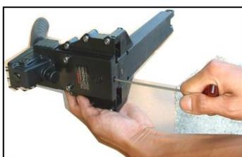
ОСЛАБЬТЕ УСТАНОВОЧНЫЙ ВИНТ (504) 3 ММ ГАЕЧНЫМ КЛЮЧОМ, ЧТОБЫ РАЗБЛОКИРОВАТЬ РЕГУЛИРОВОЧНЫЙ СТЕРЖЕНЬ (012).
