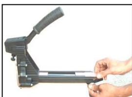
ЗАГРУЗИТЕ СКОБЫ В ИНСТРУМЕНТ, СЛЕДУЯ ПУНКТУ «ЗАПРАВКА ИНСТРУМЕНТА».
