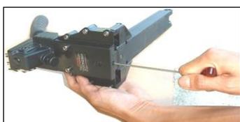
ОСЛАБЬТЕ УСТАНОВОЧНЫЙ ВИНТ (504) 3 ММ ШЕСТИГРАННЫМ ГАЕЧНЫМ КЛЮЧОМ.
