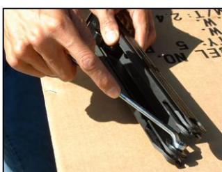
ОСЛАБЬТЕ ШТИФТ (026) 6 ММ КОЛЕНЧАТЫМ ГАЕЧНЫМ КЛЮЧОМ И ВЫНЬТЕ НАПРАВЛЯЮЩИЕ ТОЛКАТЕЛЯ (033).
