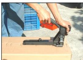
УСТАНОВИТЕ ИНСТРУМЕНТ НА КОРОБЕ В МЕСТЕ, ПРЕДНАЗНАЧЕННОМ ДЛЯ СКОБЫ. ПО ОБЕИМ СТОРОНАМ МАГАЗИНА (032) РАСПОЛОЖЕНЫ НЕБОЛЬШИЕ ВЫСТУПЫ, КОТОРЫЕ УКАЗЫВАЮТ НА ПОЛОЖЕНИЕ СКОБЫ. ПРИДЕРЖИВАЯ ОДНОЙ РУКОЙ КОРПУС ИНСТРУМЕНТА (001) СПЕРЕДИ, НАЖМИТЕ РУЧКУ (002). ЗАТЕМ ПЕРЕДВИНЬТЕ ИНСТРУМЕНТ НА СЛЕДУЮЩУЮ ПОЗИЦИЮ.
