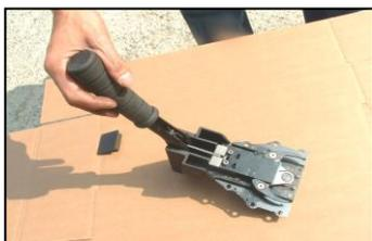
ВЫНЬТЕ РЫЧАЖНЫЙ МЕХАНИЗМ И РЕГУЛИРОВОЧНЫЙ СТЕРЖЕНЬ (012) ОДНОВРЕМЕННО ИЗ ВОРОТА (001).
