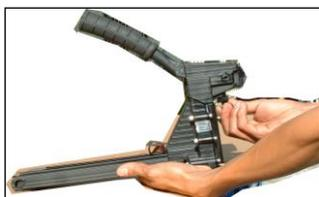
ОСЛАБЬТЕ РЕГУЛИРОВОЧНУЮ ГАЙКУ (011), ПОВЕРНИТЕ РЕГУЛИРОВОЧНЫЙ ВИНТ (010) ПО ЧАСОВОЙ СТРЕЛКЕ, ЧТОБЫ УМЕНЬШИТЬ СИЛУ СЖАТИЯ СКОБЫ.
