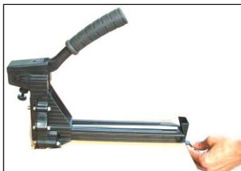
ПОТЯНИТЕ ТОЛКАТЕЛЬ (036) ТАК, ЧТОБЫ ОН УПЕРСЯ В ПЯТКИ (032), ЗАТЕМ ПОВЕРНИТЕ ТОЛКАТЕЛЬ.
