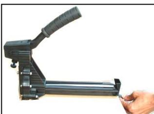
ОТТЯНИТЕ ТОЛКАТЕЛЬ (030) НАЗАД ТАК, ЧТОБЫ ОН ЗАФИКСИРОВАЛСЯ НА СТЕРЖНЕ (026). ПОВЕРНИТЕ ТОЛКАТЕЛЬ (030), ЧТОБЫ ЗАФИКСИРОВАТЬ.
