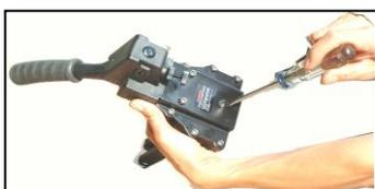
ПОВЕРНИТЕ РЕГУЛИРОВОЧНЫЙ СТЕРЖЕНЬ (012) НА 180° ДО ЖЕЛАЕМОГО УРОВНЯ ПРИ ПОМОЩИ ОТВЕРТКИ.
