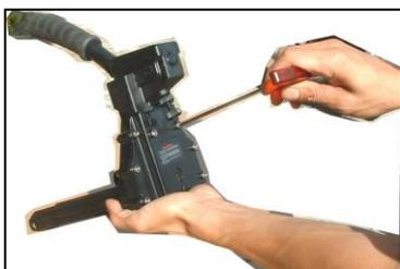
ОСЛАБЬТЕ ПЕРЕДНИЙ ВИНТ (527) ШЕСТИГРАННЫМ ГАЕЧНЫМ КЛЮЧОМ 6 ММ.
