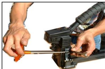
ОСЛАБЬТЕ ВИНТЫ (508), (509) И ГАЙКУ (520) 8 ММ ГАЕЧНЫМ КЛЮЧОМ И 4 ММ ШЕСТИГРАННЫМ ГАЕЧНЫМ КЛЮЧОМ.
