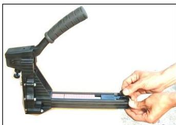
ПОДВИНЬТЕ ТОЛКАТЕЛЬ (036) НАЗАД И ПОСТЕПЕННО ОТПУСТИТЕ ЕГО ТАК, ЧТОБЫ ТОЛКАТЕЛЬ УПЕРСЯ В СКОБЫ. СЛЕДИТЕ, ЧТОБЫ ТОЛКАТЕЛЬ НЕ УДАРЯЛСЯ В СКОБЫ С СИЛОЙ: ЭТО МОЖЕТ ПРИВЕСТИ К ДЕФОРМАЦИИ СКОБ ИЛИ ПОВРЕЖДЕНИЮ ИНСТРУМЕНТА.
