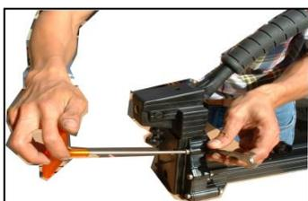
ОСЛАБЬТЕ ВИНТЫ (508), (509) 8 ММ ГАЕЧНЫМ КЛЮЧОМ И 4 ММ ШЕСТИГРАННЫМ ГАЕЧНЫМ КЛЮЧОМ.
