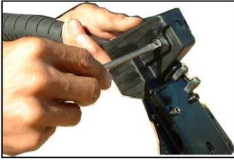
ОСЛАБЬТЕ ВИНТ ПЯТКИ (006) ОТВЕРТКОЙ С ПЛОСКОЙ ГОЛОВКОЙ. СНИМИТЕ РУЧКУ (002) И РЫЧАЖНЫЙ МЕХАНИЗМ.
