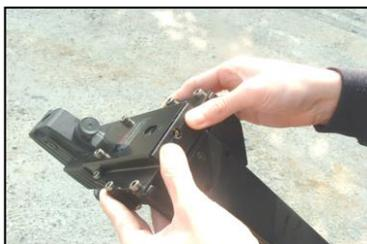
ПРОТОЛКНИТЕ КОРПУС (001) ВВЕРХ И ОТРЕГУЛИРУЙТЕ В СООТВЕТСТВИИ С НЕОБХОДИМОЙ ГЛУБИНОЙ ВХОДА СКОБЫ.
