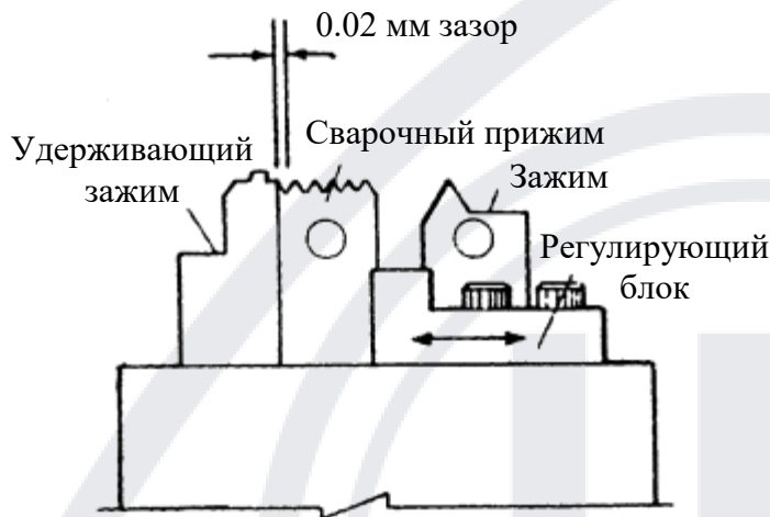
Рис. 24 Сварочный прижим и удерживающий зажим
